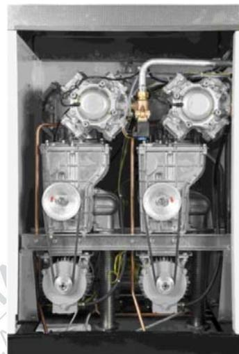
Рисунок 13 – Модуль гидравлики ТРК, сторона А
